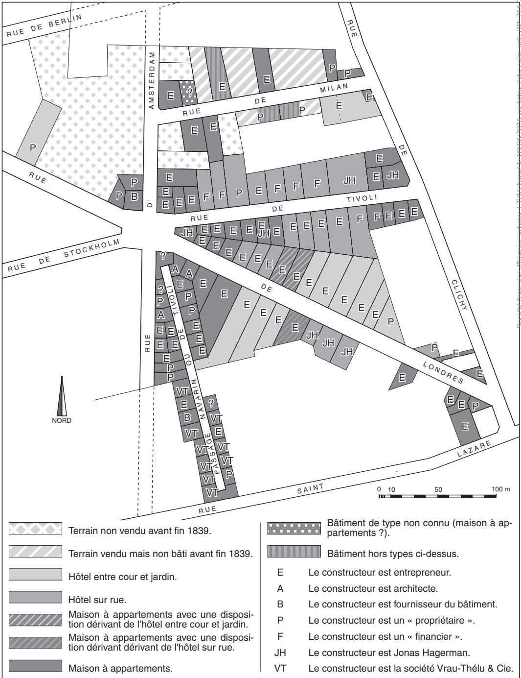
Figure 5 : Types bâtis : localisation et constructeurs (dessin A. Térade)
