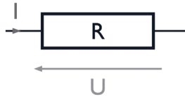
Image 1. Modélisation matérielle de la loi d'Ohm
